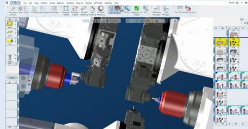
工具主軸とワーク主軸の回転方向表示
